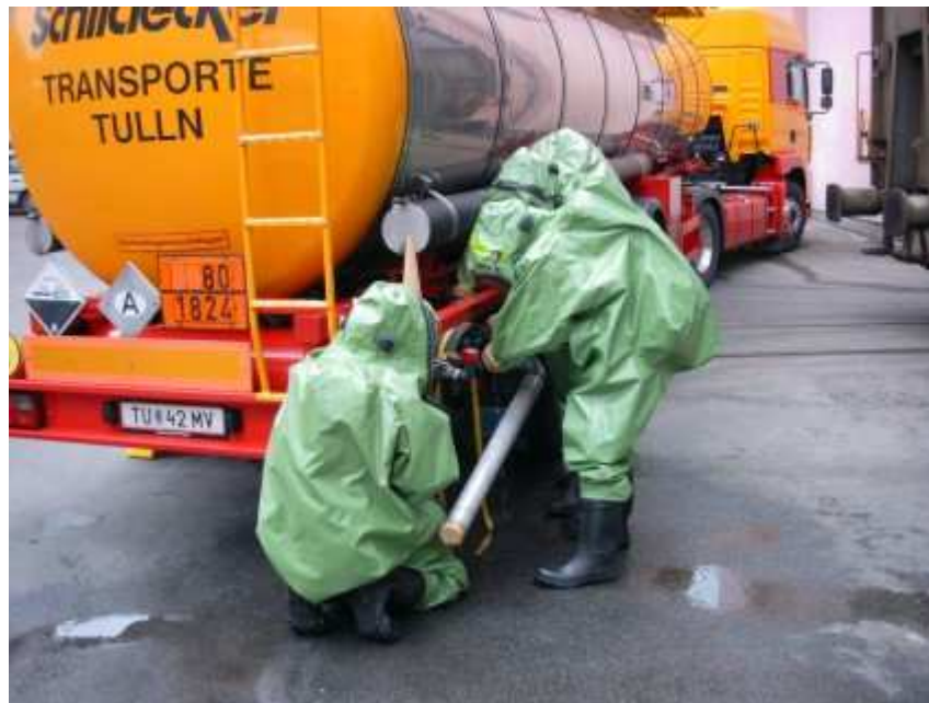
Abdichten der Flüssigkeitsaustrittsstelle
