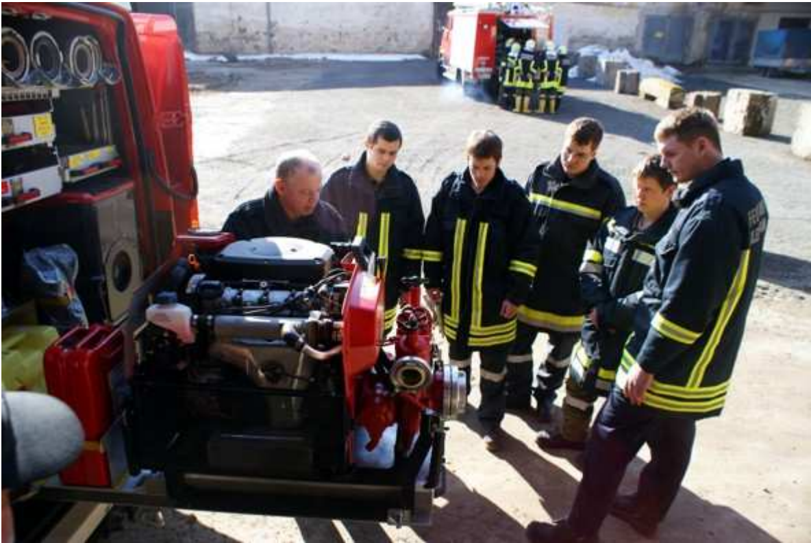
2: Tragkraftspritze. OLM Bauer erklärt die Bedienung, Funktion und Instandhaltung für die verschiedenen Modelle von Tragkraftspritzen.
