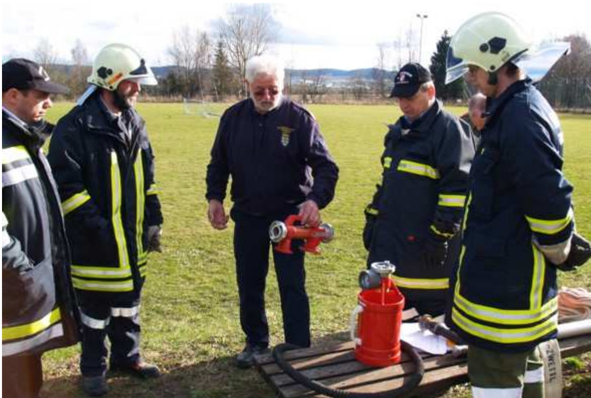
7: Überprüfung: Mit Prüfkarteiblättern werden einzelne Feuerwehrgeräte einer Sicht- und Funktionsprüfung unterzogen.
