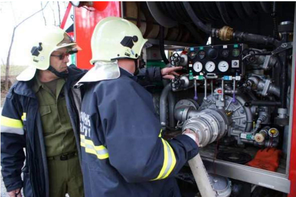
3: Einbaupumpe: Die Kursteilnehmer lernen den Umgang und die Einsatzmöglichkeiten von Feuerlöschpumpen in Tanklöschfahrzeugen.
